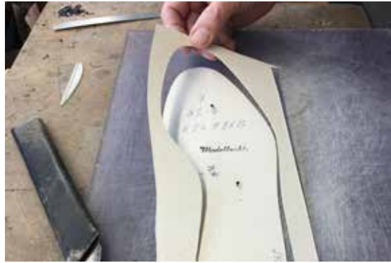
Abschliff: Das Erstellen von Schablonen für die Modellsohlen gehört ebenfalls zum Arbeitsfeld von Schmidt.
