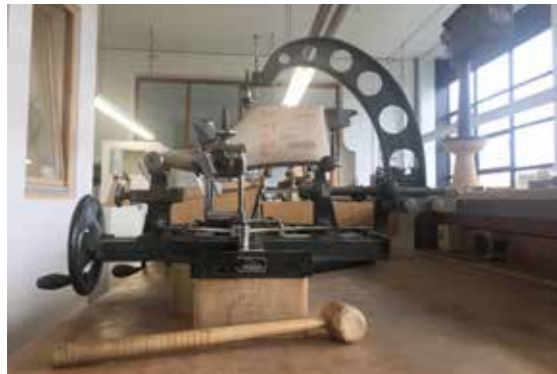
Täglich im Einsatz: Der Messpunkt-Markierungsapparat. Hier wird der Messbereich des Umfangmaßes der Leiste mithilfe des Messpunkt-Markierungsapparates in Bezug auf den Goldenen Schnitt definiert.
